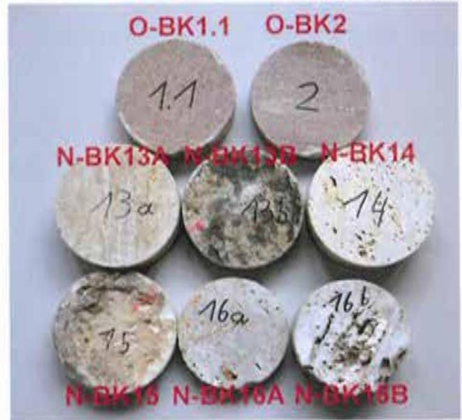
Bild 1: Ansichten der Saugflächen – diese Fläche wurde während der Prüfung in Wassergetaucht – ausgewählten Probekörper von
