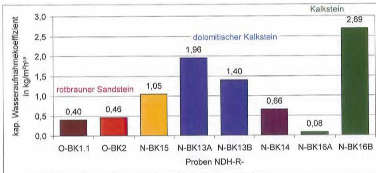
Abb. 3.7.2: Kapillare Wasseraufnahmekoeffizienten für Natursteinproben
