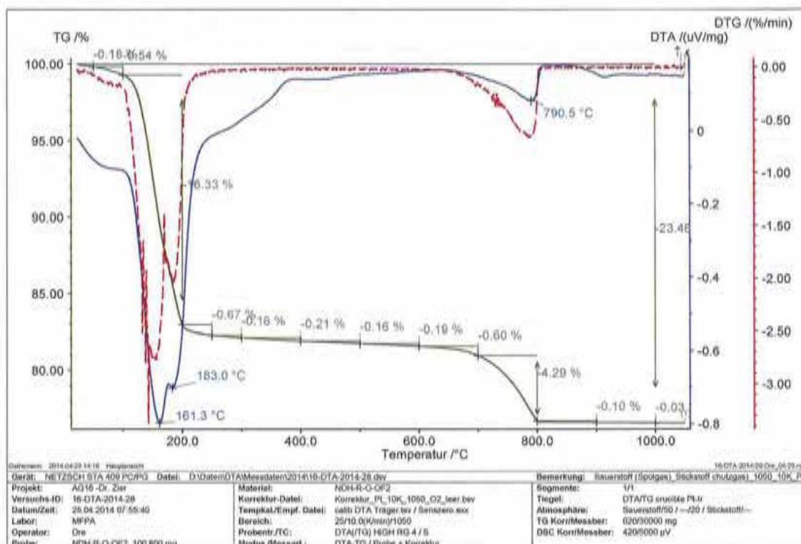
Abb. 3.3.8: DTA-, DTG- und TG-Kurven der Beschichtung NDH-R-O-OF2
