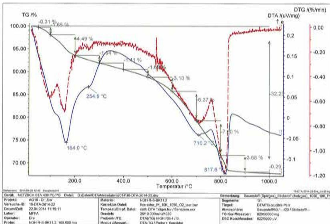
Abb. 3.3.7: DTA-, DTG- und TG-Kurven der Verfugmörtelprobe NDH-R-S-BK11.2
