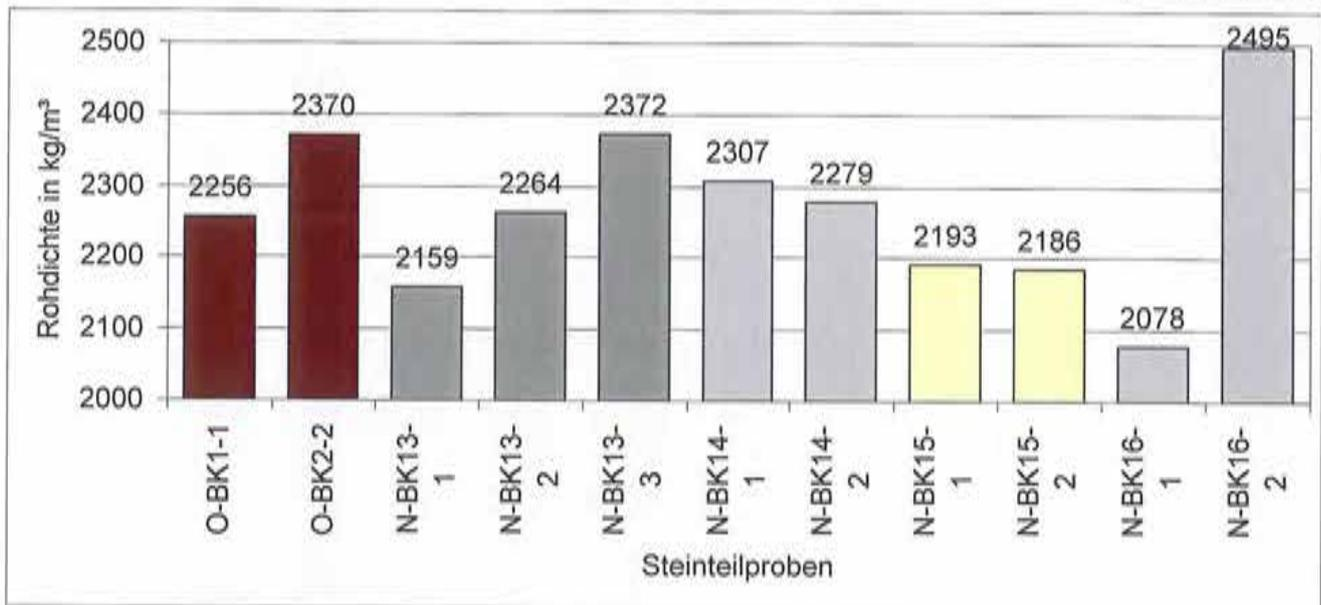
Abb. 3.6.1: Rohdichten von Natursteinproben
