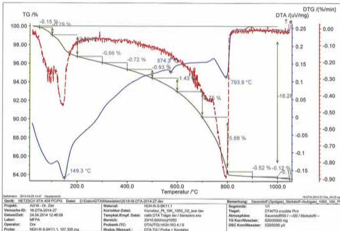
Abb. 3.3.6: DTA-, DTG- und TG-Kurven der Verfugmörtelprobe NDH-R-S-BK11.1
